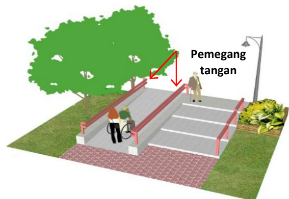
Rajah 18 : Ilustrasi bagi penyediaan pemegang tangan ( hand railing ) bagi kegunaan golongan OKU
